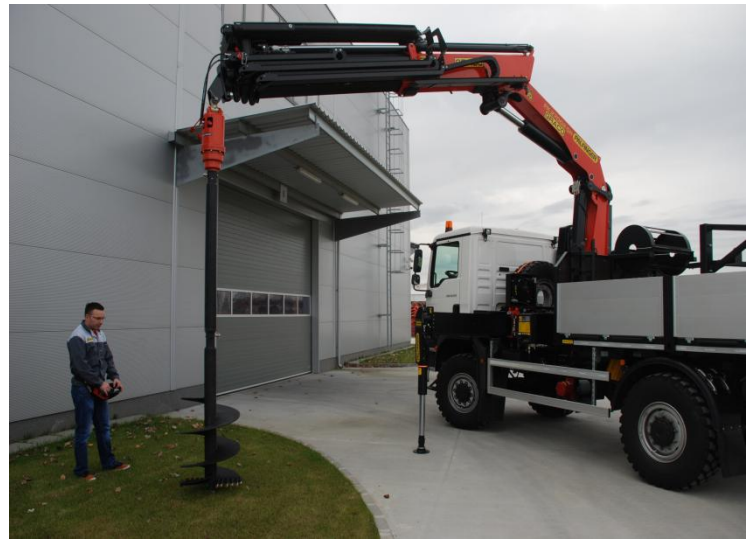
ŻURAW W POZYCJI ROBOCZEJ ZE ŚWIDREM ZIEMNYM
